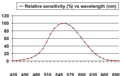
■ **Sensors:** Silicon photodiode
